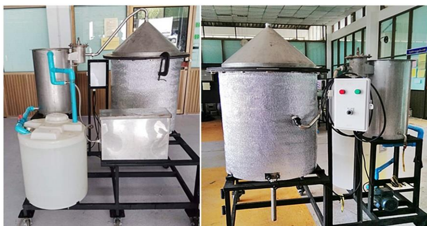
ภาพที่ 2-18 เครื่องสกัดน้ำมันหอมระเหยด้วยน้ำและไอน้ำ (จิระศักดิ์ เพียรเจริญ และจารุวัฒน์ เจริญจิต, 2546)
