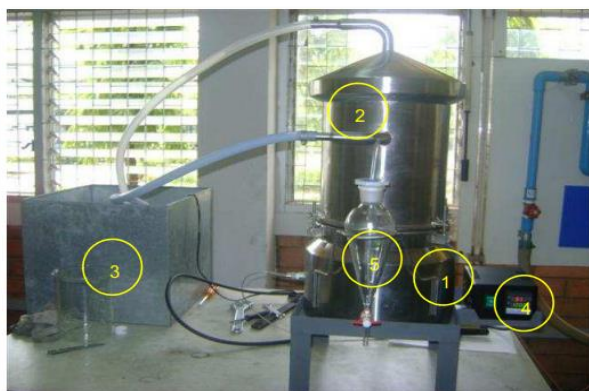
ภาพที่ 2-23 แสดงเครื่องกลั่นน้ำมันหอมระเหยขนาดเล็ก (นฤเบศร์ หนูไสเพ็ชร และอุดม รินคำ, 2555)
