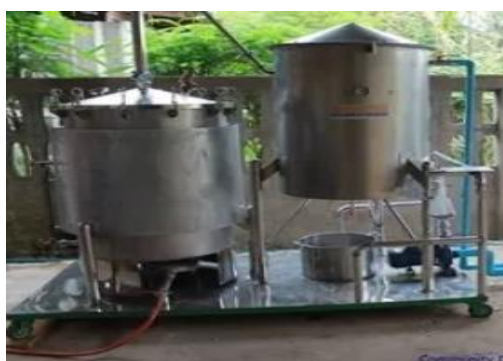
ภาพที่ 2-19 แสดงเครื่องสกัดน้ำมันหอมระเหยจากขิง (ธีรศิลป์ ชมแก้ว, 2551)
