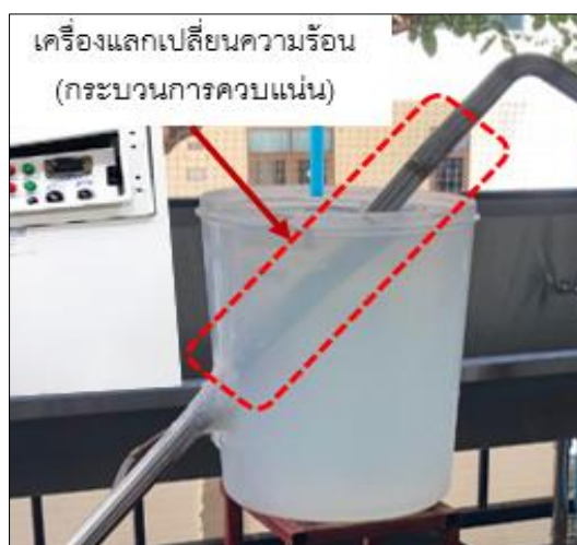
ภาพที่ 3-6 แสดงเครื่องแลกเปลี่ยนความร้อน
