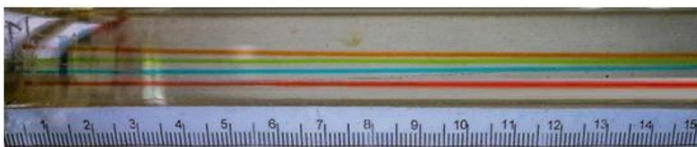
ภาพที่ 3-3 แสดงโครงสร้างกระบวนการไหลของของไหลในท่อเปล่า
