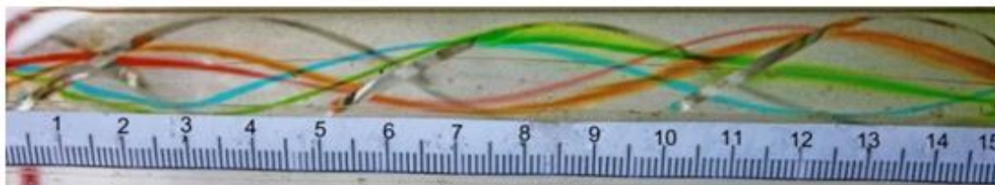
ภาพที่ 3-4 แสดงโครงสร้างกระบวนกรไหลของของไหลในท่อสอดใส่อุปกรณ์สร้างการไหลหมุนวน
