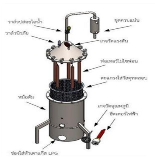
ภาพที่ 2-24 แสดงเครื่องกลั่นน้ำมันหอมระเหยแบบเทอร์โมไซฟอน (นำพล พิพัฒน์ไพบูรณ์ และคณะ, 2557)
