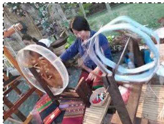
ภาพที่ 4.28 ไน (อุปกรณ์กรอเส้นด้ายเข้าหลอด)
