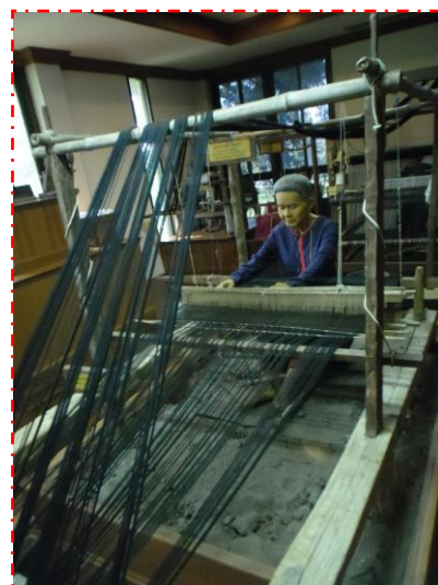
ภาพที่ 4.27 แคร่เดินด้าย ( อุปกรณ์เรียงเส้นด้ายเส้นยืน)
