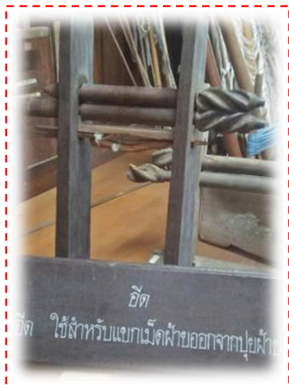
อีต ใช้สำหรับแยกเม็ดฝ้ายออกจากปุยฝ้าย
