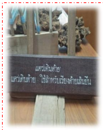
ภาพที่ 4.27 แคร่เดินด้าย ( อุปกรณ์เรียงเส้นด้ายเส้นยืน)
