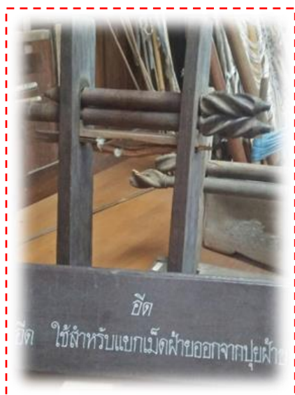
อีต ใช้สำหรับแยกมัดฝ้ายออกจากปุยฝ้าย
